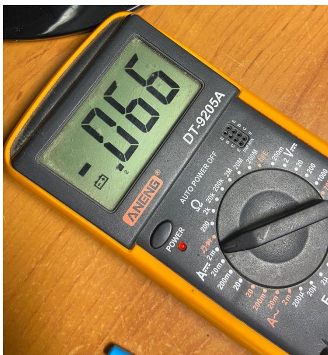
Рисунок .7. Измерение мощности солнечной батареи в калькуляторе с помощью мультиметра
