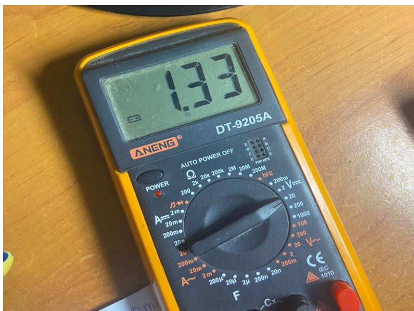
Рисунок 9. Замер заряда аккумуляторной батареи через 60 минут
