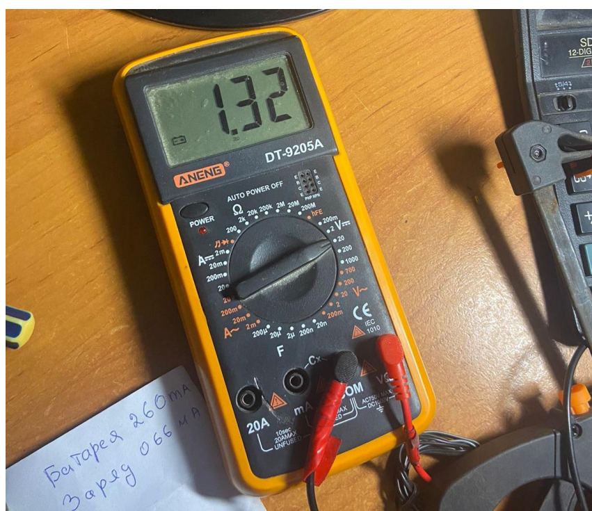
Рисунок 6. Измерение мощности аккумуляторной батареи мультиметром
