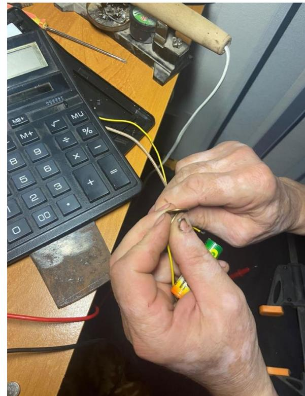
Рис.2. Разбираем калькулятор. Припаиваем провода и медные пластины.
